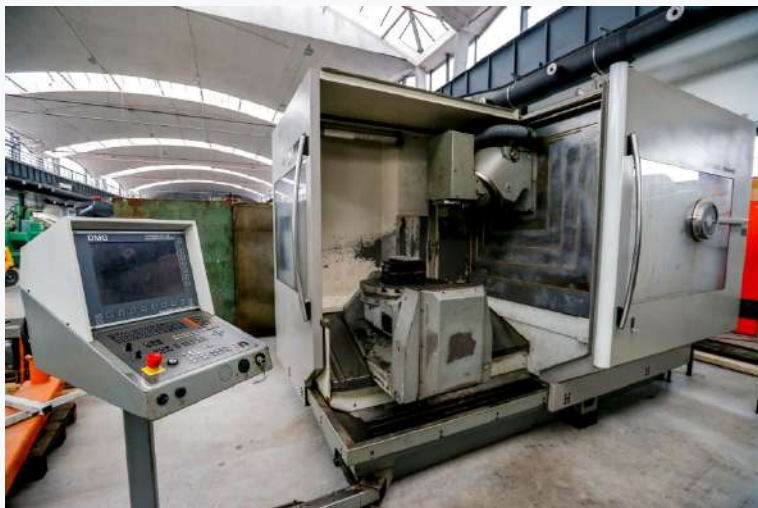
DMG DMU 80P 5 teng. megmunkáló központ X:800 mm; Y:700 mm; Z:600 mm Asztal átmérő: 630 mm Maximális munkadarab súly: 600 kg
