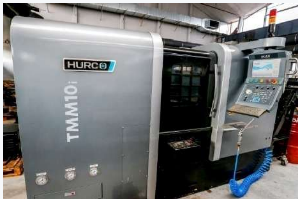
Hajtott szerszámos eszterga HURCO TMM 10i X:250 mm; Z:750 mm; \varnothing =295 mm
