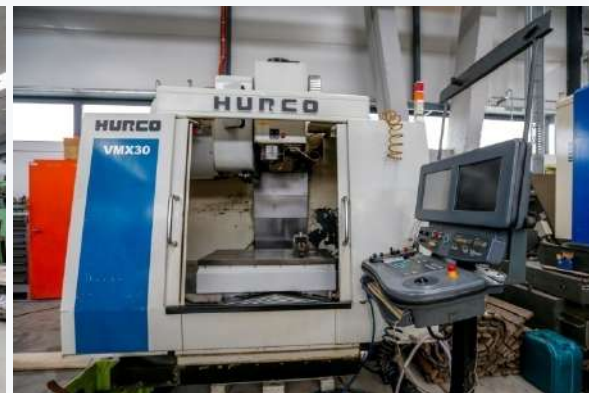
3 tengelyes maró – Hurco VMX30 X:760 mm; Y:510 mm; Z:610 mm
