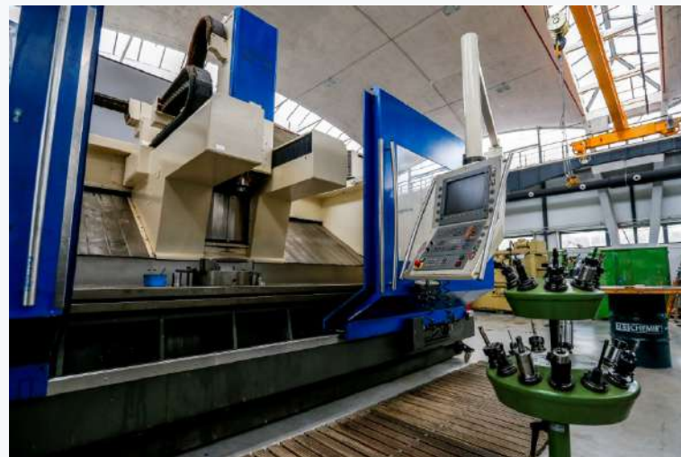
HEDELIUS BC100 3 tengelyes marógép X:3500 mm; Y:1000 mm; Z:770 mm Maximális munkadarab súly: 4.500 kg
